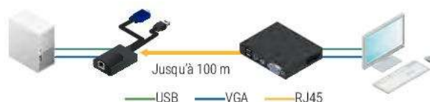
Emetteur : dongle VGA / USB
